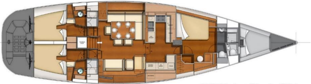
BORDEAUX 60' version propriétaire avant avec lit latéral BORDEAUX 60' forward owner's cabin layout with lateral bed
